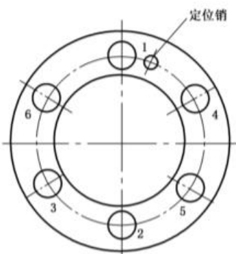
图 2-1：塔筒筒节连接螺栓分布示意图
